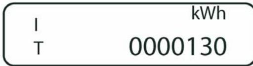
Betriebsanzeige wechselt automatisch zwischen Normallast T1 und Schwachlast T2 (Intervall 30 Sek.) Aktueller Stand Energie Normallast T1
