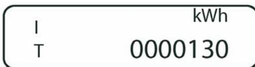
Tippen Sie 4x auf die **Anzeigetaste** bis Ihnen der aktuelle Stand **Energie Normallast T1** angezeigt wird.
